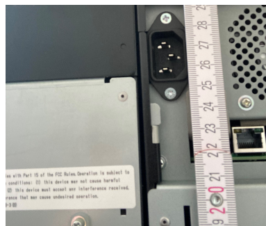
CI-5, Kabelanschluss am Automaten
